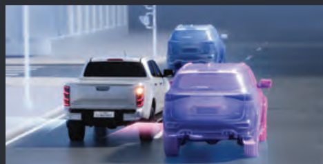
ใหม่! ELK (Emergency Lane Keeping) ระบบช่วยควบคุมรถให้อยู่ในเลน ในสถานการณ์ฉุกเฉิน
