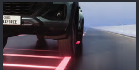
ใหม่! LDP (Lane Departure Prevention) ระบบช่วยควบคุมรถไม่ให้ออกนอกเลน พร้อม LDW (Lane Departure Warning) ระบบช่วยแจ้งเตือนเมื่อรถออกนอกเลน
